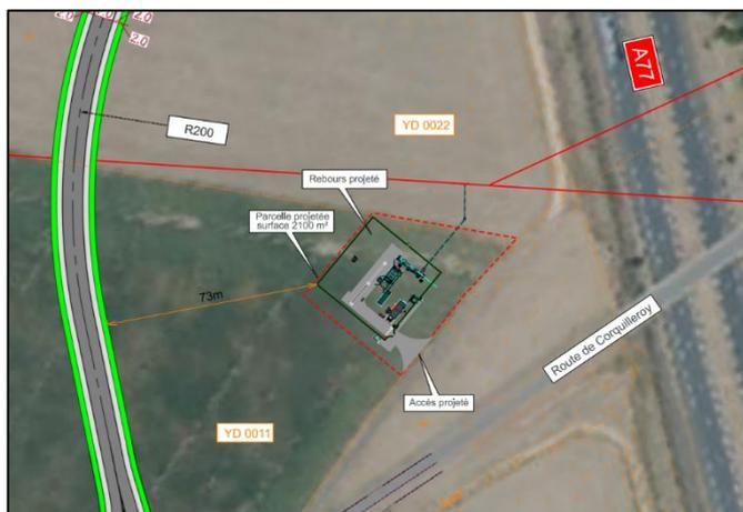
Figure 1 Plan de masse de l'implantation du poste de rebours sur la parcelle YD-11 à Pannes. Source : Cub n04524724A0038
